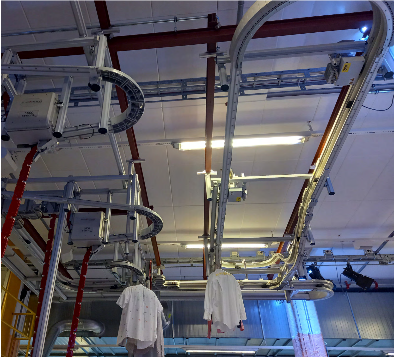
Kuva 2. Linjasto, joka kuljettaa tekstiilin kuvattavaksi ja tunnistettavaksi konenäön avulla. Lijasto löytyy Boråsista ( https://dotankcenter.se/ )
